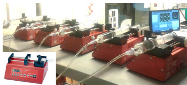
Figure 3. Mise en œuvre des pousse-seringues de notre stimulateur
