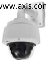
Le modèle de caméra AXIS Q6035-E PTZ Dome Network, illustrée par la **Figure 12** ci-contre, est une caméra grand public, qui sert généralement à faire de la surveillance de site. Elle est étanche, pilotable et dirigeable à distance via le réseau internet. Sa direction, sa résolution, son zoom et fréquences des prises de photos automatiques sont programmables.
