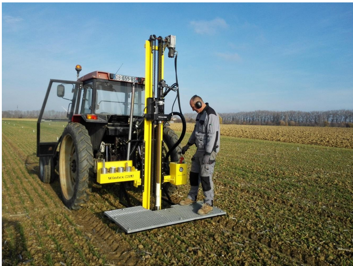
Photo 10. Pose de tubes sans tassement des cultures (ici, du blé, à Auzeville) (Photo : R. Marandel).
