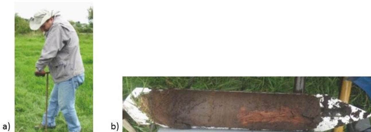
**Figure 2.** Carottages palynologiques manuels avec la sonde GYK. a) extraction de la carotte sur le terrain ;
