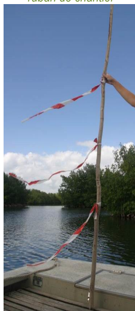
Photo 4. Perche en bois graduée et ruban de chantier
