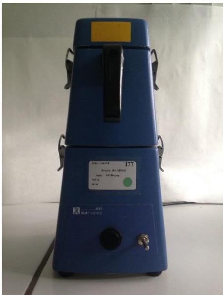
**Photo 1.** Broyeur M20 (Photo : Patrice Soulé, USRAVE, INRA).
