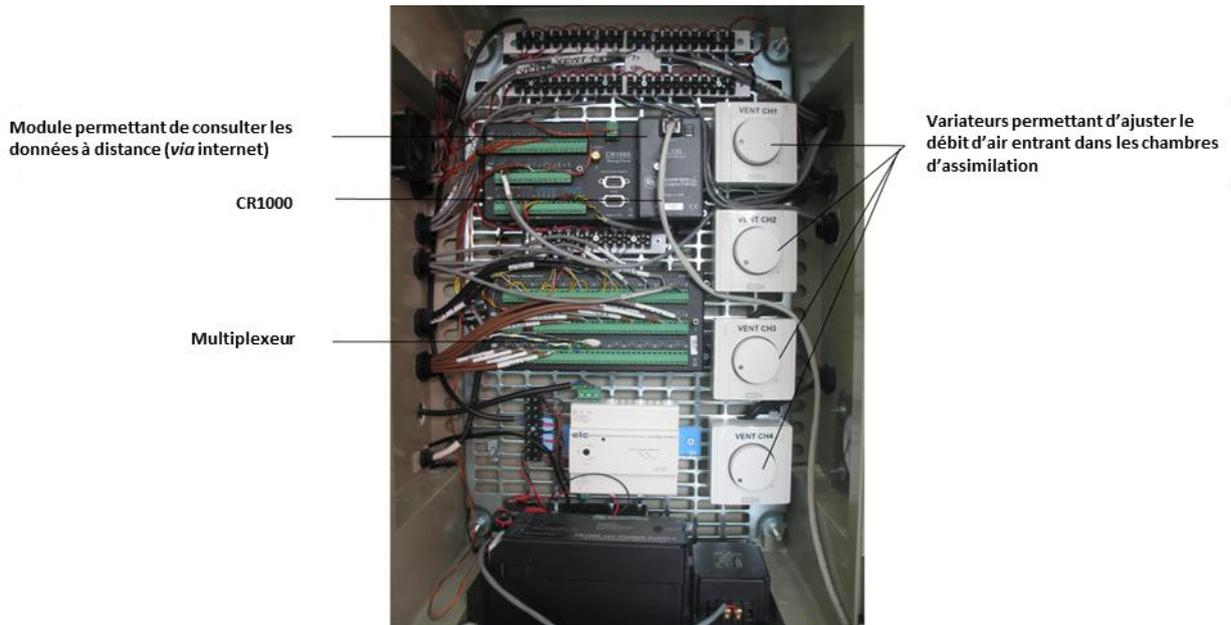
Figure 15. CR1000 et variateurs permettant de régler le débit d'air entrant dans les chambres. (Photo : LEPSE)
