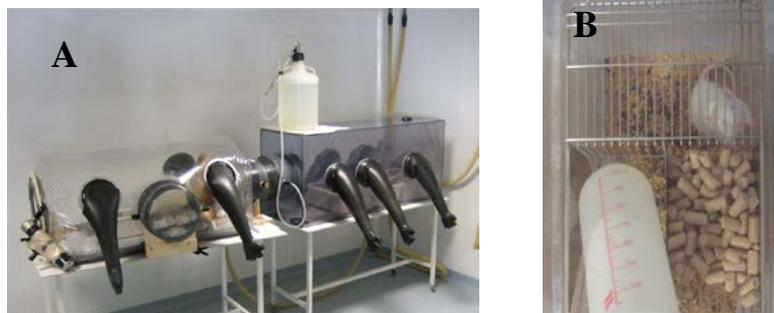
**Figure 1.** Isolateur d'élevage stérile (A) contenant les cages des rongeurs (B).
