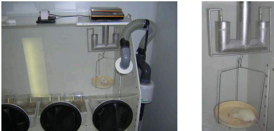
**Figure 3.** Photos du SYSPA lors de la pesée d'un rat.
