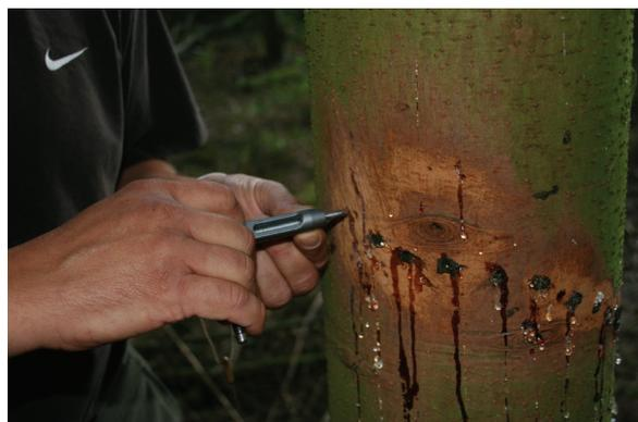
Il est conseillé de taper un minimum de fois pour essayer d'écraser le moins possible la zone cambiale. Il est important que le tube coupant soit bien perpendiculaire au tronc (c'est-à-dire perpendiculaire aux fibres du bois) pour pouvoir faire ensuite des coupes anatomiques dans le plan radial-tangentiel qui nous intéresse. La tête du *Trephor* est retirée du tronc à la main en se servant des bras asymétriques pour faire tourner l'appareil comme un tire bouchon (**photo 3**).
