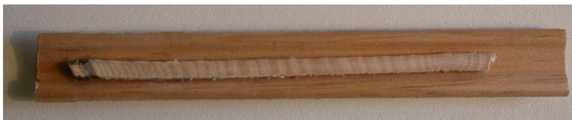
Photo 9 © J. Willm/Inra : carotte collée sur baguette
