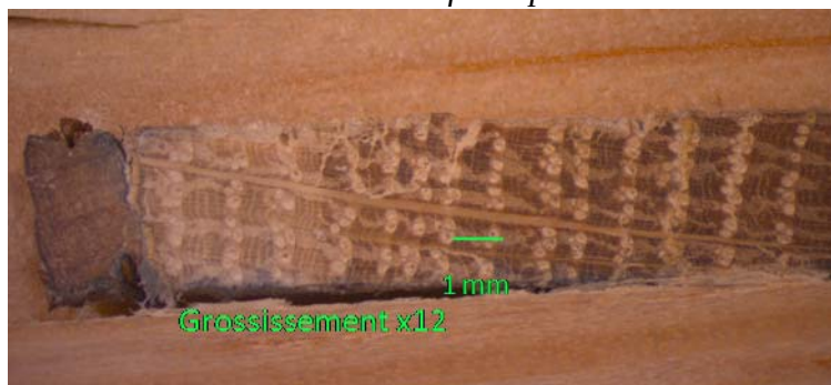
Photo 12 © L. Burnel/Inra : carotte de chêne poncée et collée sur baguette
