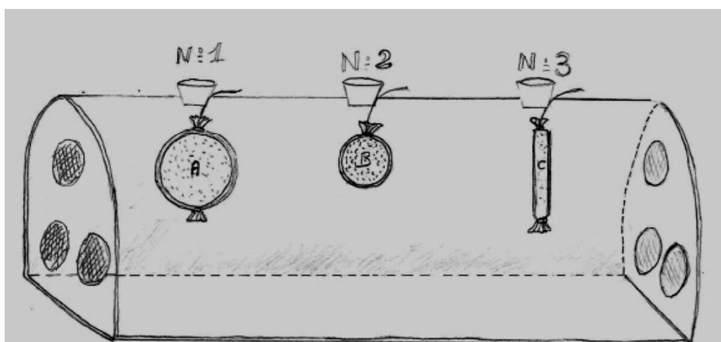
**Figure 3 : Dispositif utilisé pour les expériences de choix de substrat (L 60 cm x L 30 cm x H 35 cm)**
