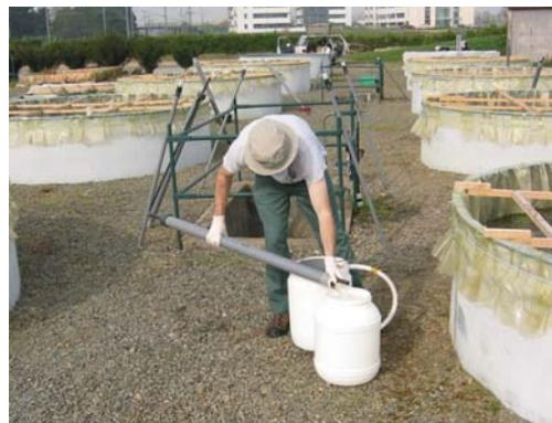
**Photo 3** : Récupération du contenu d'un préleveur à tube coulissant
