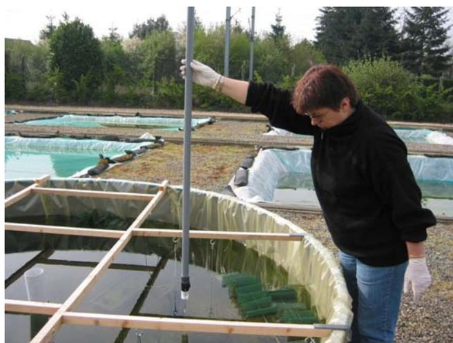
**Photo 1 :** Utilisation d'un préleveur à clapet anti-retour dans un mésocosme
