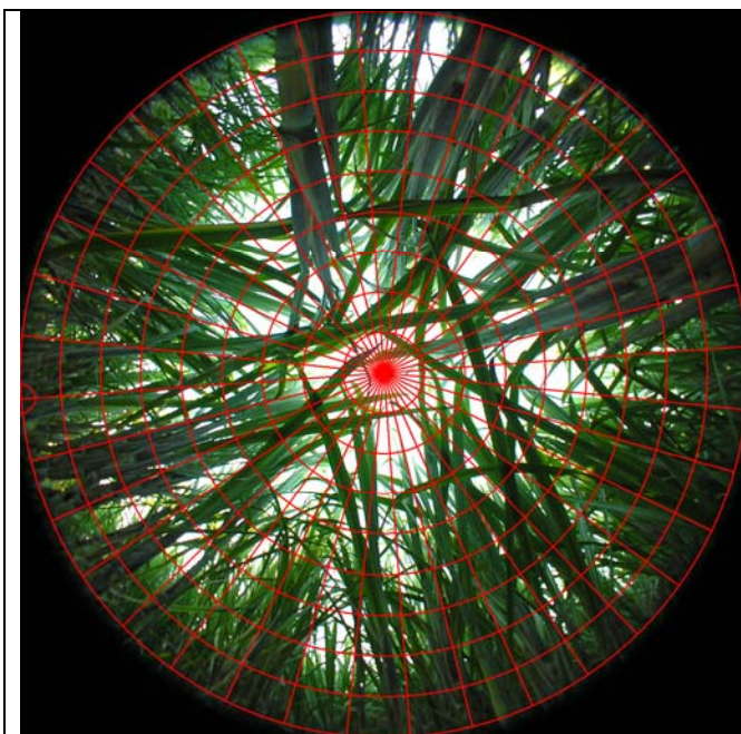
Figure 1a : Photographie hémisphérique d'un couvert de canne à sucre ; une grille permet de repérer les hauteurs zénithales et les azimuts.
