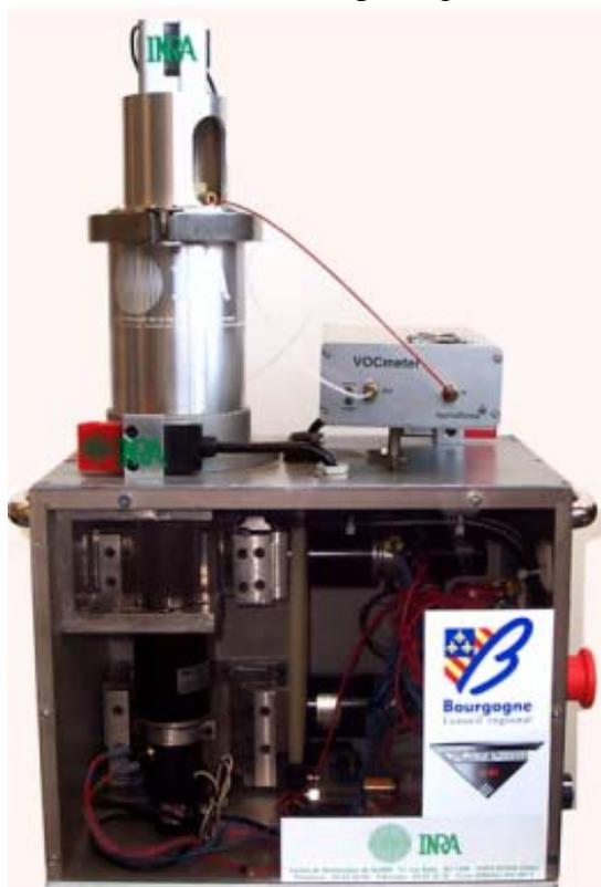
Figure 1 : Vue globale de la bouche artificielle (Photo P. Mielle)
