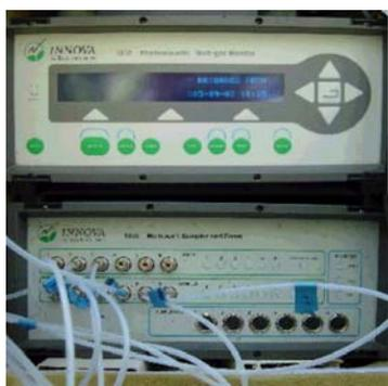
a/ Analyseur 5 gaz et échantillonneur-doseur
