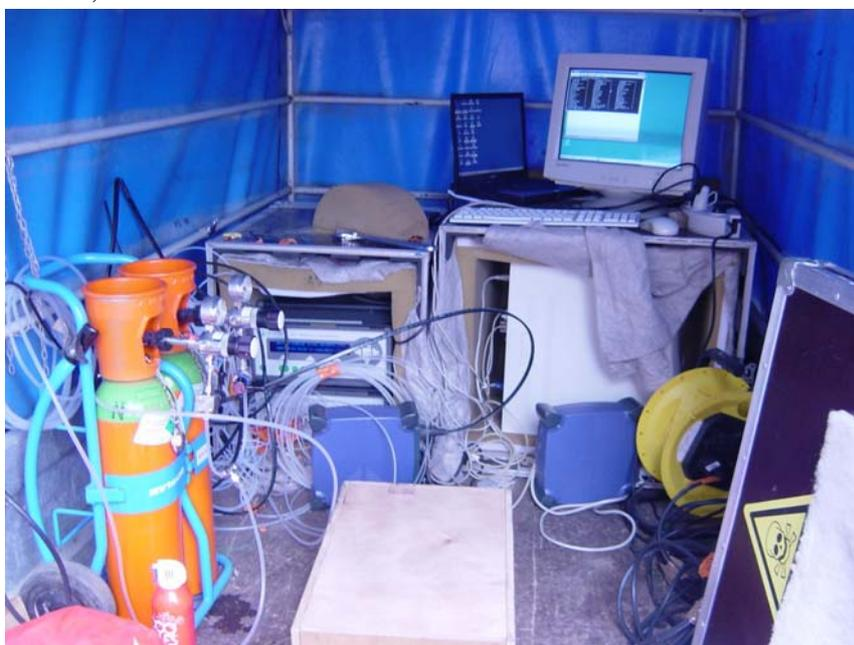
**Photo 1 :** Dispositif mobile de mesure des émissions gazeuses des bâtiments d'élevage et au stockage des effluents
