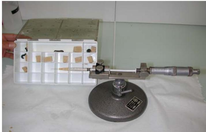
**Photo 2 :** *Micro-injecteur et boîte compartimentée contenant un  $\text{cm}^3$  de milieu artificiel où sont placées les larves après injection*
