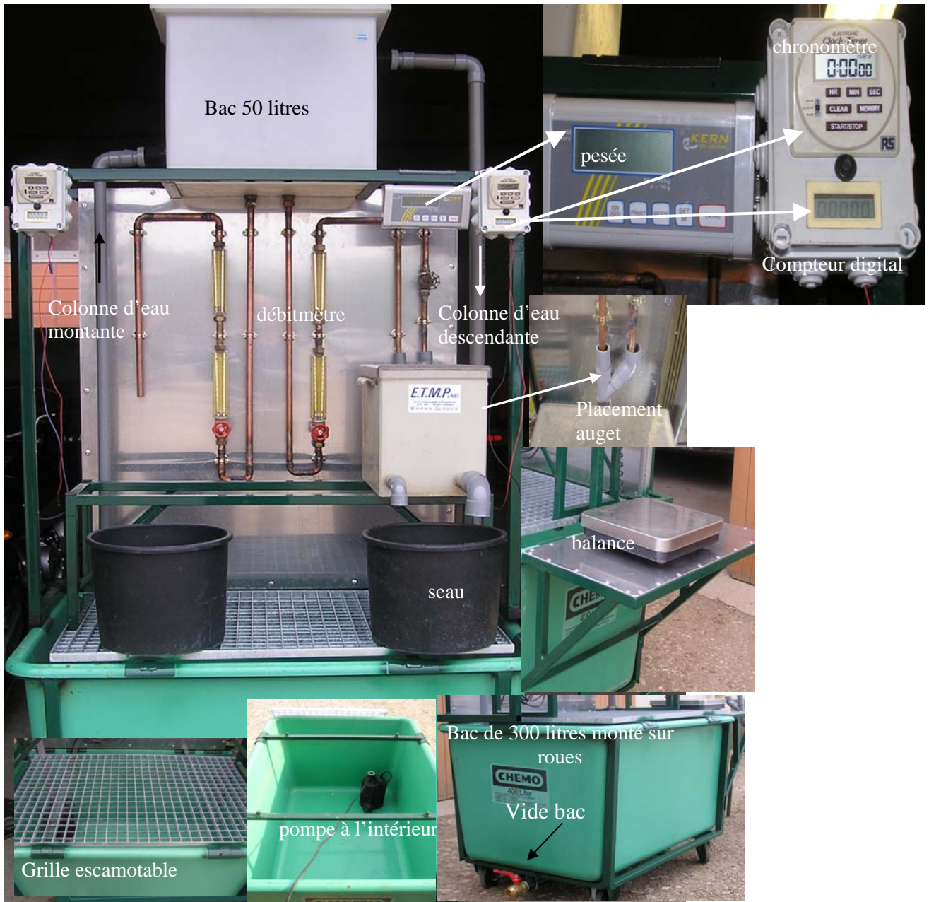
Photo 2: Vues générales du banc d'étalonnage et de ces différents composants
