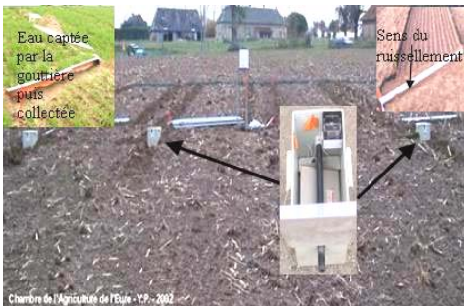
Photo 1 : dispositif de mesure du ruissellement en parcelle agricoleur
