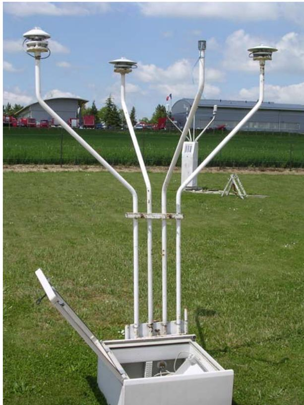
**Photo 1** : *Dispositif de mesure du rayonnement global*
