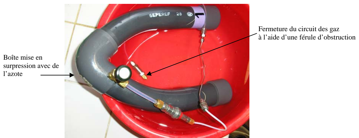
Figure 5: Localisation des fuites dans le circuit de prélèvement des gaz par immersion dans l'eau
