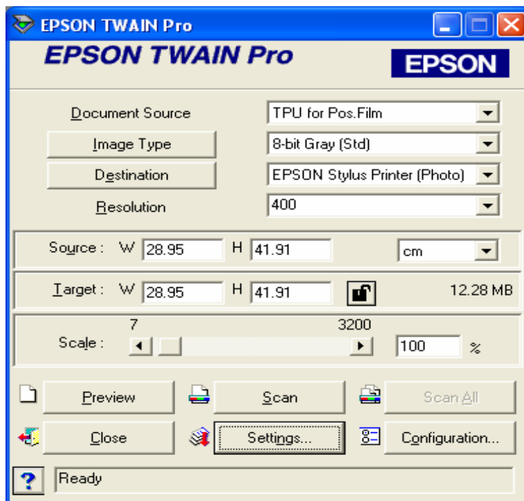
Figure 2 : Réglages du scanner EPSON TWAIN PRO
