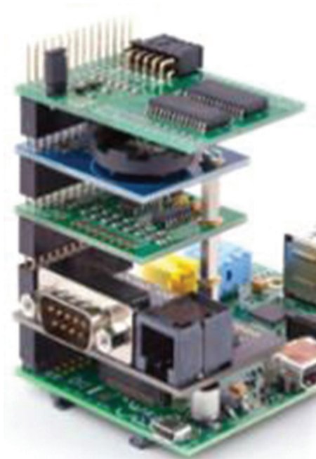
Figure 2. RPI avec cartes optionnelles (www.framboise314.fr).
