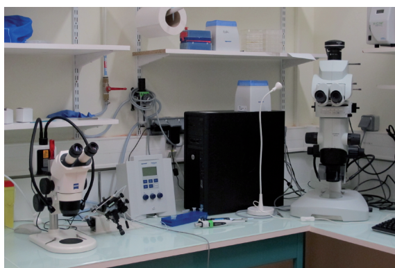
Figure 4. Système pour micro-injections et observations (photo : M. Frayssinet).
