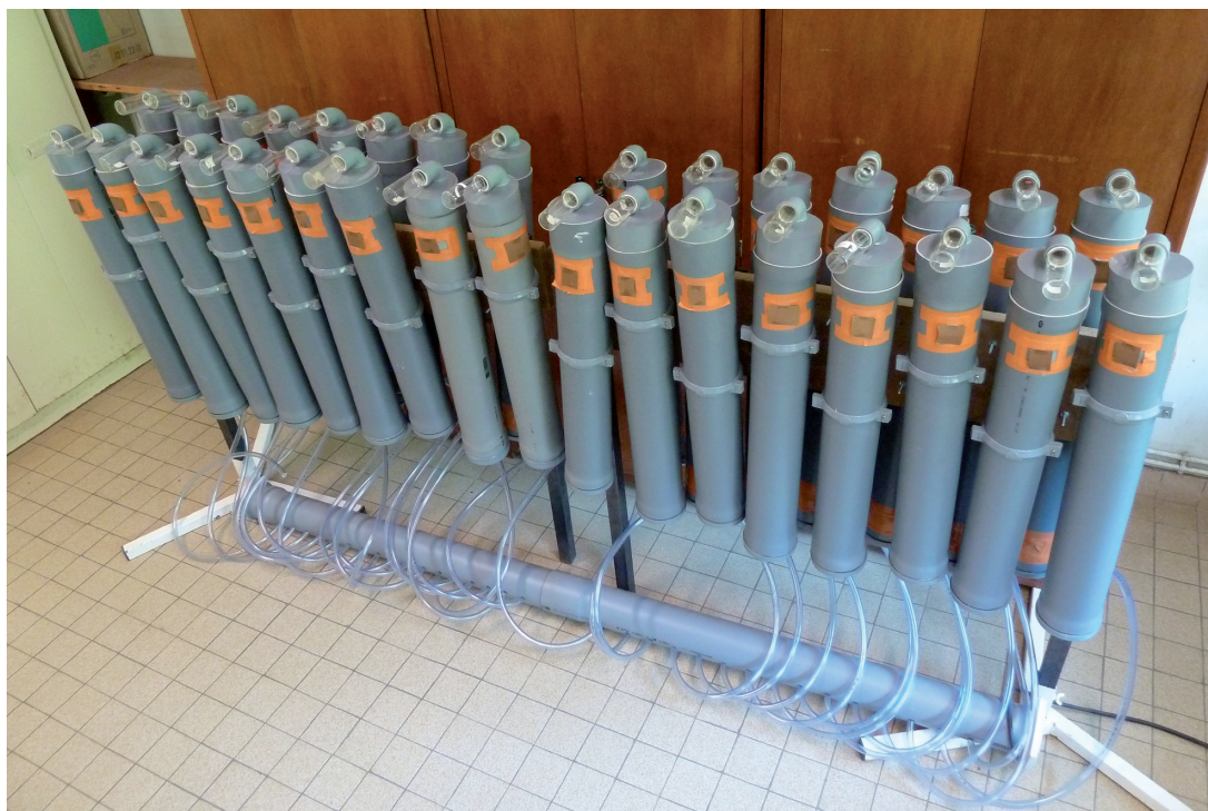
Figure 10. Dispositif d'émergence de micro-hyménoptères parasitoïdes assemblé (photo : K. Morel).
