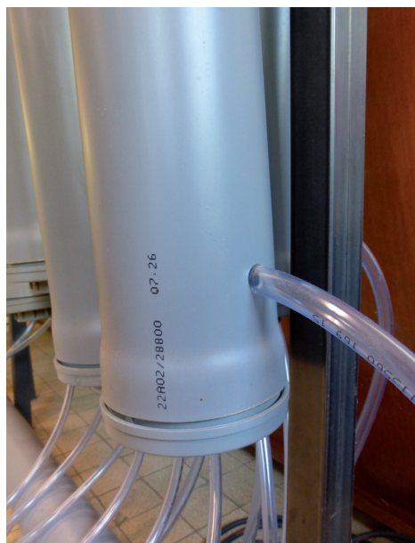
Figure 9. Mise en place du tuyau d'aération dans la partie basale du tube d'émergence (photo : K. Morel).
