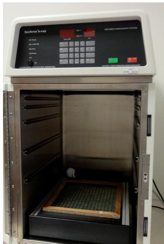
Figure 2. Scanner à rayons X Faxitron avec une plaque en position basse. La source de rayons X et le scanner se trouvent respectivement sur le haut et sur le bas de l'appareil. Il existe plusieurs niveaux de positionnement de la plaque, qui sera alors plus ou moins proche de la source des rayonnements. Cela conditionne la surface radiographiée : un rapprochement vers la source produit un effet de zoom qui réduit la taille de la surface radiographiée mais qui est adapté à de petits échantillons (photo : M. Parizat).
