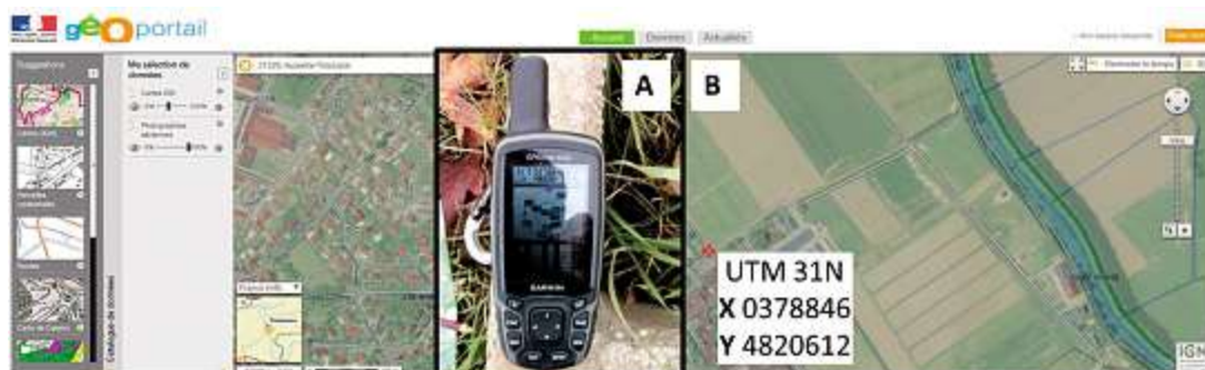
Figure 8. Résultat d'un relevé GPS et coordonnées correspondantes sur le Géoportail IGN. L'encart A (photo : S. Ladet) illustre la page satellite du GPS Garmin 62 ST lors de la relève avec 7 satellites captés et les coordonnées métriques renvoyés en UTM zone 31 (à savoir X=378846 et Y=4820613). La partie B illustre la lecture des coordonnées de ce coin de parcelle (croix rouge) sur le Géoportail sur un fond de carte composite construit à partir de la photo aérienne et de la carte topographique. Cet ensemble de données est en accord, à un mètre près, avec les données de notre GPS Garmin 62st.
