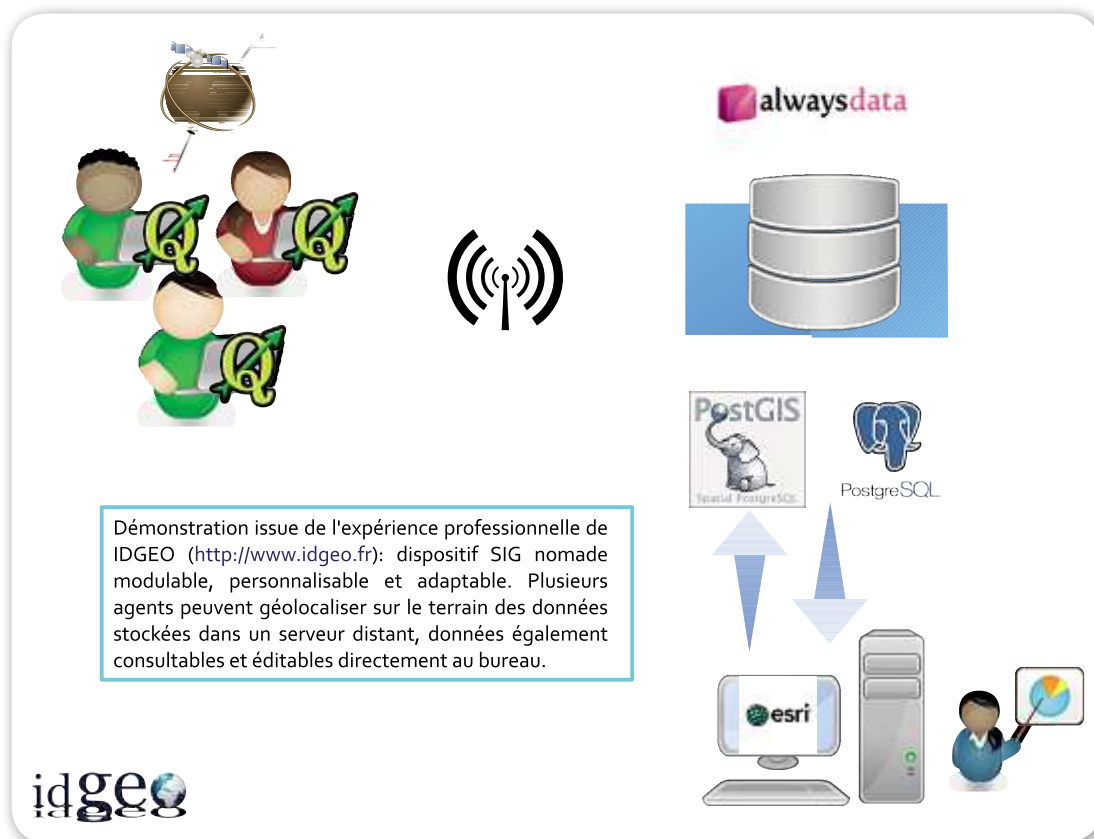
Figure 5. Infrastructure d'un SIG nomade permettant l'édition multi-utilisateur sur le terrain et la visualisation des modifications en direct au bureau.
