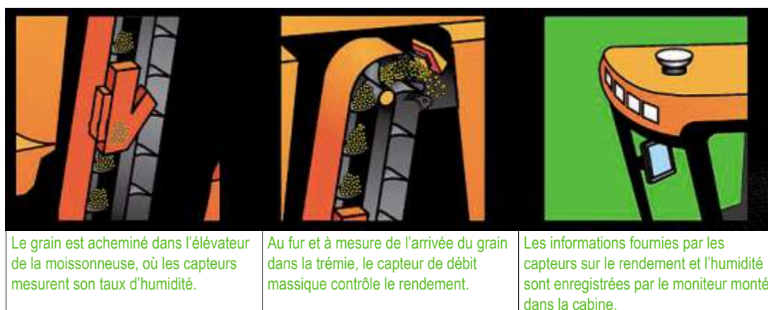
Figure 6. Schéma de montage d'un capteur de rendement et d'humidité sur une moissonneuse-batteuse.
