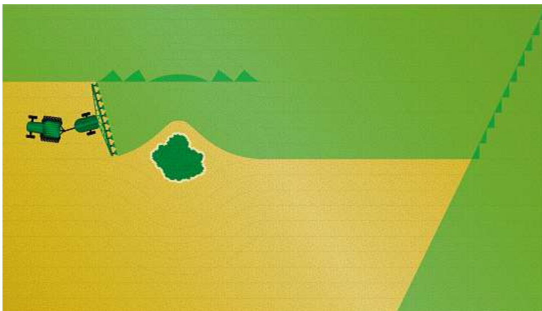
Figure 5. Illustration du fonctionnement des coupures de tronçon.
