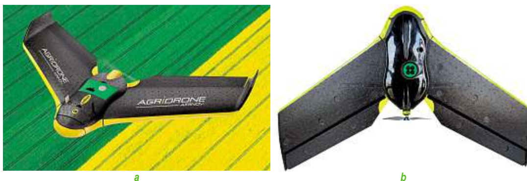
Figure 1 (a). Le drone eBee de senseFly (b) équipé du capteur MultiSpec 4C d'AIRINOV® (Copyright AIRINOV®).
