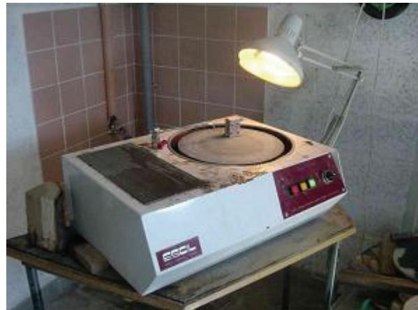
Photo 7 © Inra /Anh Tuan Dinh : polisseuse manuelle et cale
