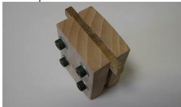
Photo 9 © Inra/P. Marchal : cale de ponçage, détail rainure
