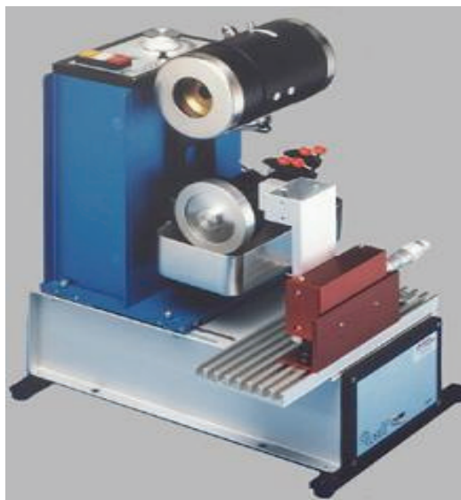
Photo 5 © ESCIL http://www.materiel-metallograp : scie à fil Well 3241
