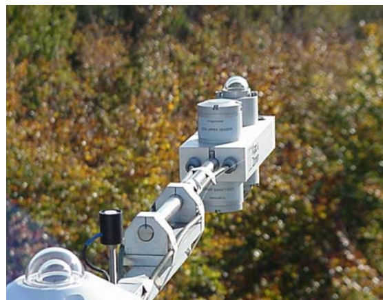
Photos 2 et 3 © Inra/Patrick Gross : Support pour capteurs de rayonnement
