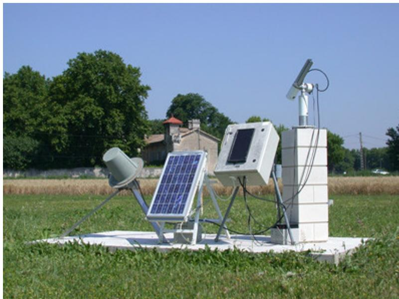
**Figure 5 :** photomètre solaire CIMEL CE318 utilisé dans le réseau AERONET
