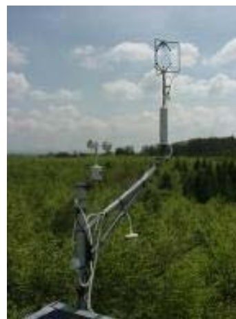
Photo 4 : Anémomètre à coupelles (en bas), et anémomètre sonique au sommet de la tour
