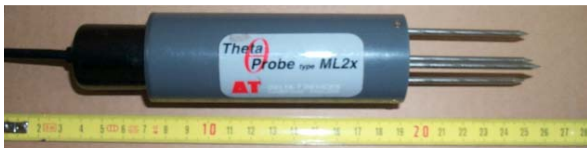
Photo 1 : Sonde Theta Probe ML2x
