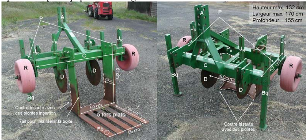
Figure 1 : Appareil d'extraction de monolithes avec roues de jauge R qui permettent de régler la profondeur, disques de découpe de la motte (D), châssis (C), attelage 3 points par chape (A), fer plat (P), fer « U » pour relier le châssis et support des disques (Pu), jauges de réglage en hauteur (J R ), coutre biseauté avec pointes d'insertion, béquilles (Bq), fixation boîte (Fb) avec un fer plat à ergots.
