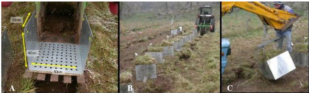
Figure 3 : Prélèvement avec le tracteur, la croix jaune indique l'emplacement des trous pour la manutention (A), la ligne de prélèvement et les monolithes conditionnés dans boîtes métalliques (B), transport de monolithes (C).
