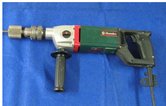
Photo 3 : carotteur à perceuse électrique (Photo F. Millier)
