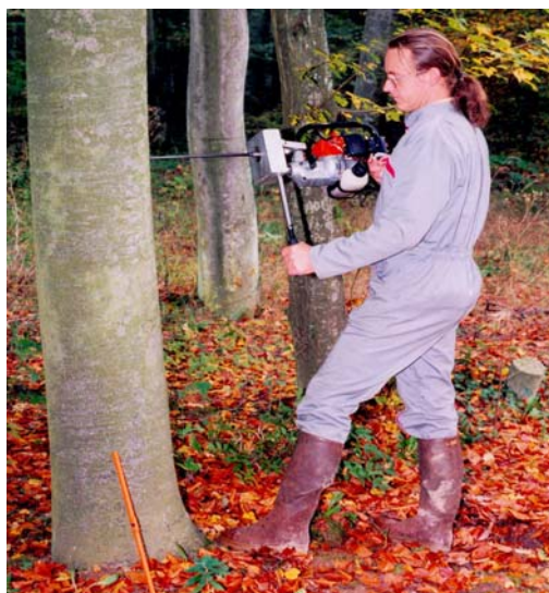
Photo 4 : vissage d'une mèche au carotteur à moteur thermique (Photo F. Lebourgeois)
