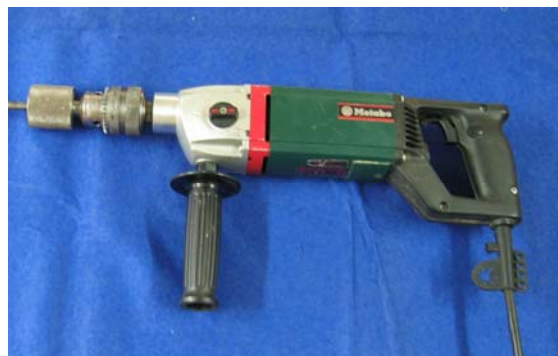
Photo 3 : carotteur à perceuse électrique (Photo F. Millier)
