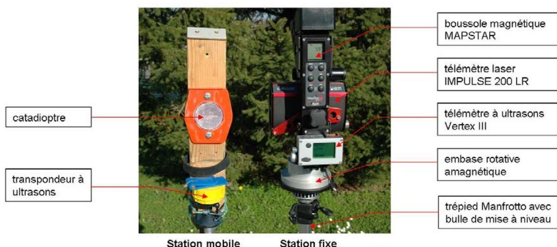
**Photo 1 :** la station de mesure comprend 7 éléments
