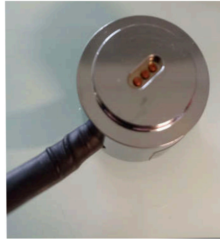
Figure 15. Chambre d'un psychromètre. (J. Cartailier)
