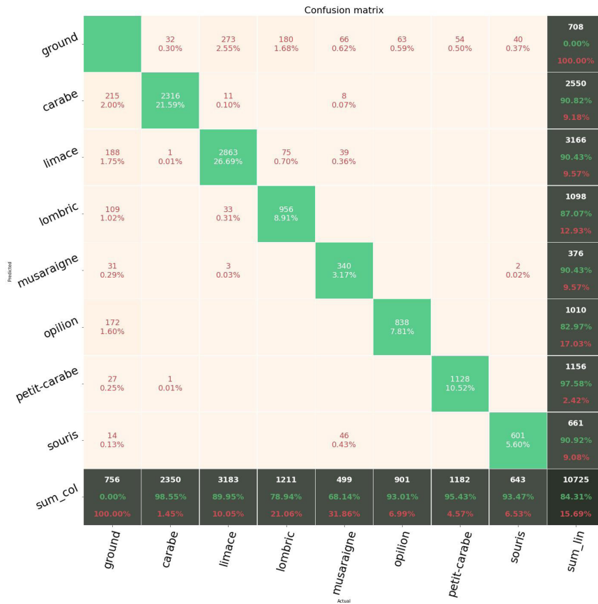
Figure 4. Matrice de confusion d'un dataset de 7 470 images et de 8 classes y compris la classe sol (ground). Cette dernière n'est pas prise en compte dans le calcul de la mAP. L'axe horizontal représente les observés (vérité de terrain) et l'axe vertical les prédictions. La ligne en bas de l'image donne la précision et les effectifs pour chaque classe et, respectivement, la colonne à droite donne le rappel et les effectifs. Les TP sont sur la diagonale en vert. Nous pouvons constater, par exemple, qu'une musaraigne est prédite comme souris dans 0,43 % des cas (FN).
