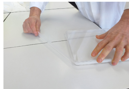
Figure 6. Ajout d'une bande de parafilm pour étanchéifier les germoirs
