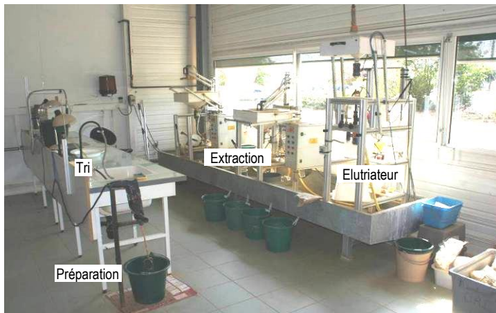
Poste de travail pour la préparation, l'extraction avec Racinator I & II, et le tri des racines et des graines des échantillons de sol A droite de la photo, Elutriateur pour l'élutriation uniquement de la fraction tamisée à 200 µm
