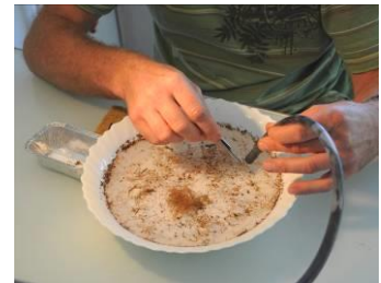
Tri manuel final dans une assiette à l'aide d'une pince et d'une trompe à eau
