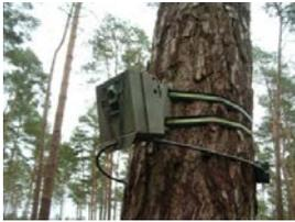
Figure 1. La caméra GameSpy modèle M-80XT de la marque Moultrie disposée dans son boîtier de protection sur un arbre à 2 mètres de hauteur.
