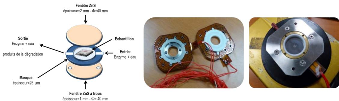
Figure 3. Schéma de la cellule microfluidique développée sur la ligne SMIS du synchrotron (Crédit photo : Marie-Françoise Devaux)
