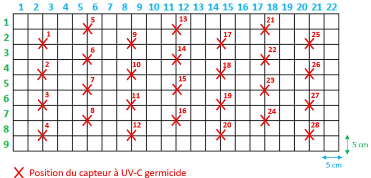
Figure 8. Schéma du positionnement du capteur à UV-C germicide sur la plateforme de traitement lumineux.
