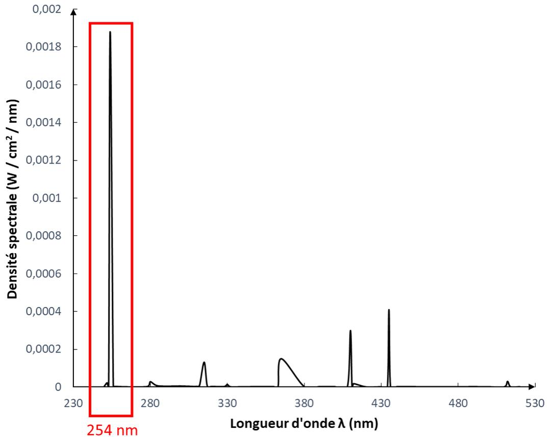
Figure 9. Spectre lumineux des lampes UV-C utilisées.
