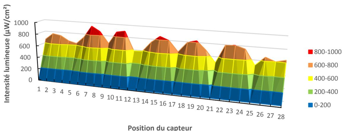
Figure 10. Intensité lumineuse induite par les lampes UV-C sur les 28 mesures réalisées à l'intérieur de l'enceinte.
