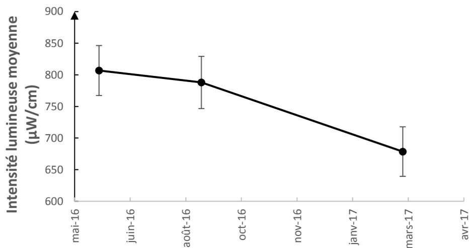
**Figure 11.** Perte de l'intensité lumineuse des lampes UV-C au cours du temps. Les mesures sont effectuées sur les 15 points de la zone de traitement UV-C.
