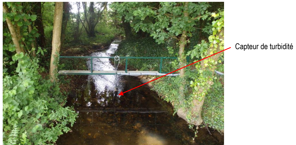
Figure 4. Fixation de la sonde de turbidité sur le ruisseau du Coët-Dan.
