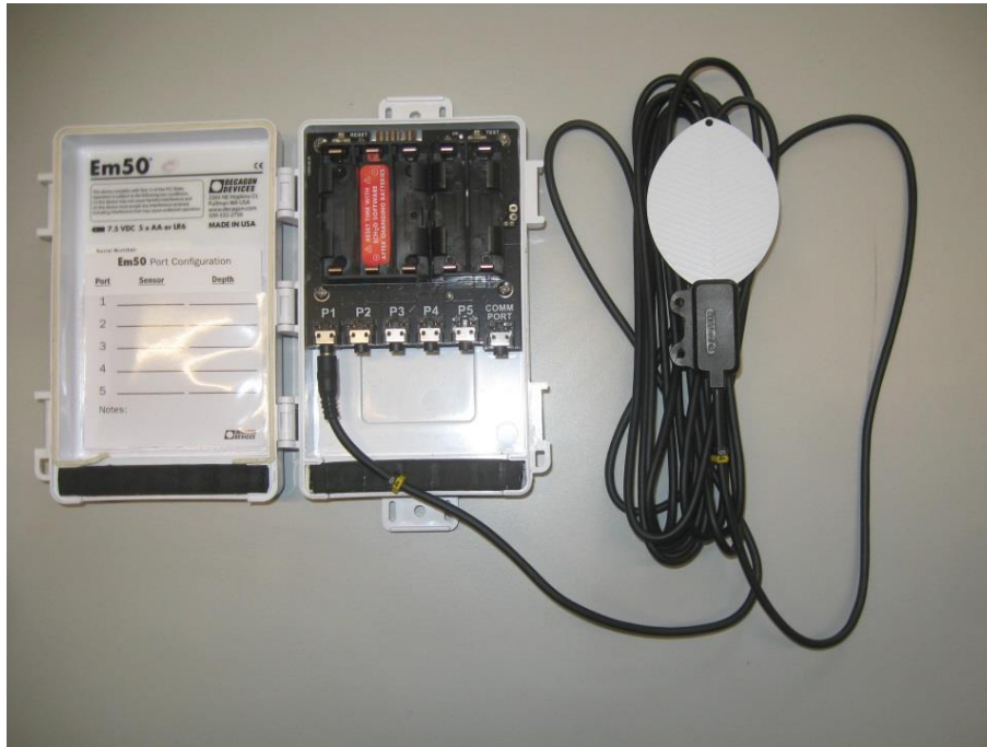
Figure 1. Présentation du matériel utilisé : centrale EM50 et sonde LWS (Photo : P. Thiébeau).
