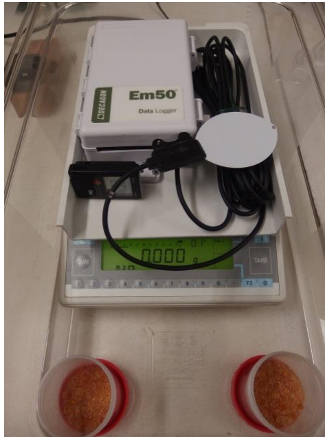
Figure 3. Dispositif à partir duquel nous avons contrôlé la réponse de capteurs LWS à la masse d'eau présente sur sa surface de mesure (Photo : G. Alavoine).
