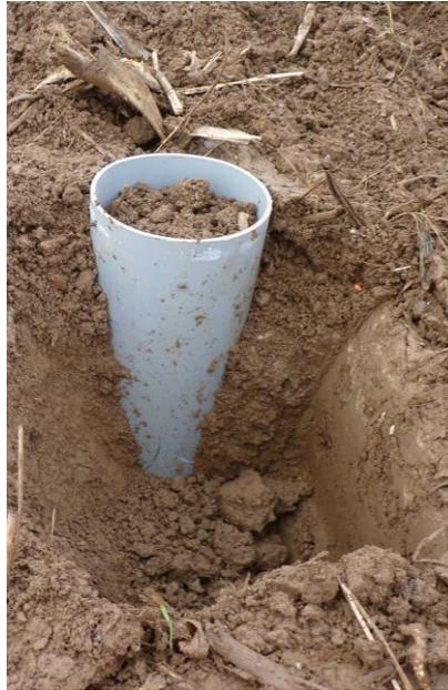
Figure 2. Exemple d'une colonne de sol enfoncée après reprise du travail superficiel (photo : Le Couteux A.)
