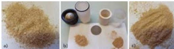
Figure 15: a) Poudre retenue par le tamis ; b) Répartition après tamisage ; c) Poudre passée au travers du tamis (Source : P. Léger)
