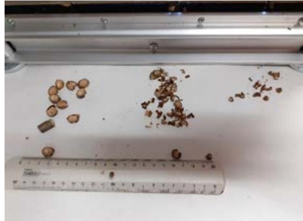
Figure 5: Coupe de différentes sections de branchettes jusqu'à 15 mm (Source P. Léger)
