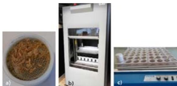
Figure 18: a) Fibres retenues par un tamis de 1 mm ; b) Agitateur SK550 ; c) Table vibrante (Source : F. Lagane & P. Léger)
