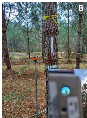
Images 2. Illustrations de la mesure de hauteur prise à la perche télescopique (A) et au dendromètre Vertex (B)
