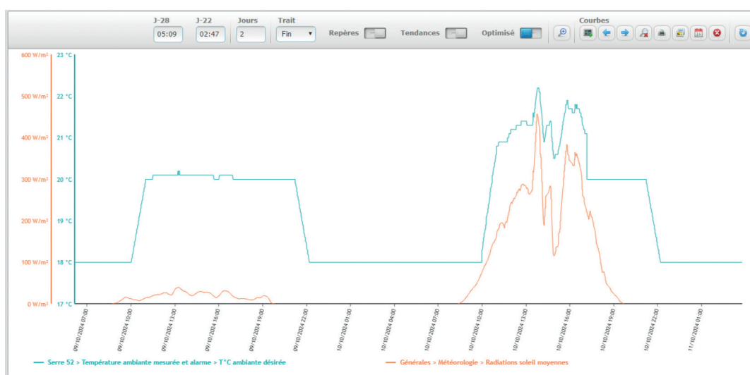
Figure 3. Visualisations de la modulation de la température désirée en fonction du rayonnement
